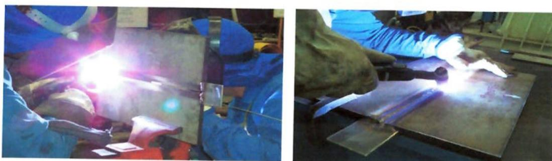
**Figura 4.3** - Soldagem dos corpos de prova (TIG).
