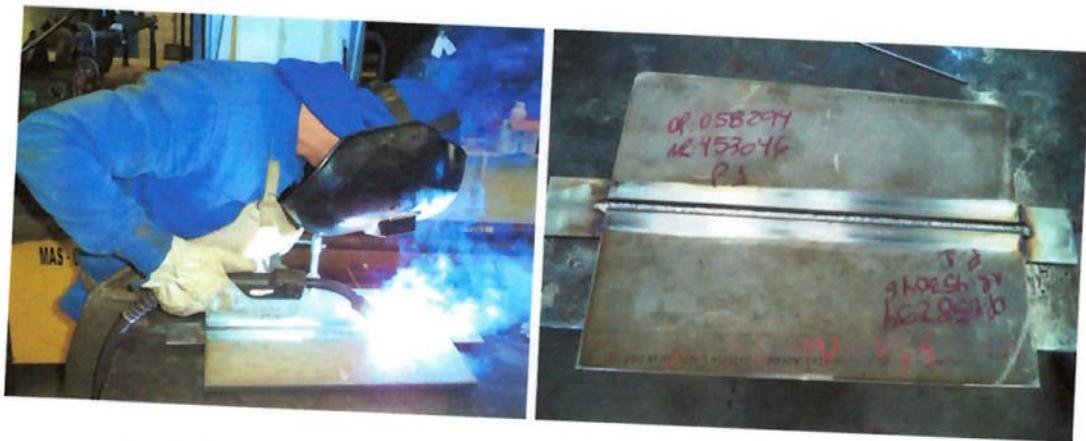
**Figura 4.7** - Foto do corpo de prova soldado (Arame Tubular).
