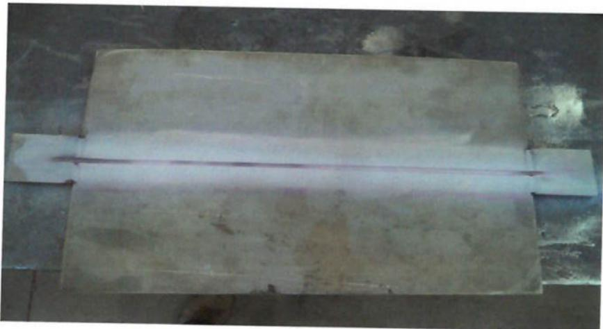
**Figura 4.10** - Foto da aplicação da revelação do penetrante.
