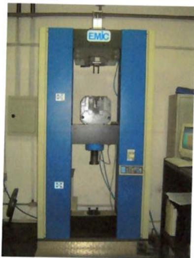
**Figura 4.15 - Máquina utilizada para realizar o ensaio de tração.**
