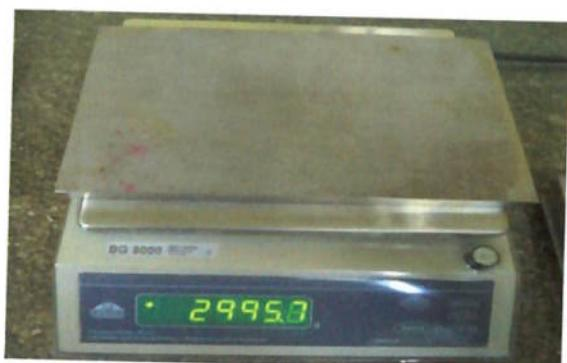
**Figura 4.13** - Foto da pesagem do corpo de prova antes da goivagem.
