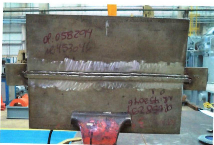
**Figura 4.11** - Foto do corpo de prova soldado (Arame Tubular).
