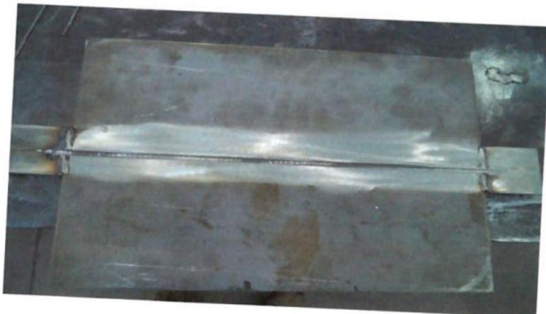
**Figura 4.8** - Foto do corpo de prova (tubular goivado).
