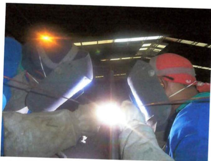
**Figura 2.12** - Soldagem com o processo TIG dupla fusão.
