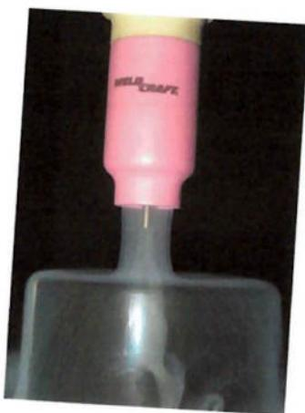
**Figura 2.7** - Fluxo do gás de proteção bocal cerâmico TIG [Cortesia Miller].
