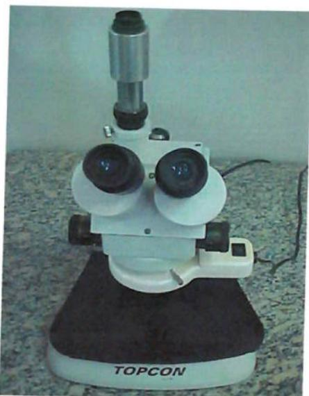
**Figura 4.23 - Microscópio estereoscópico.**
