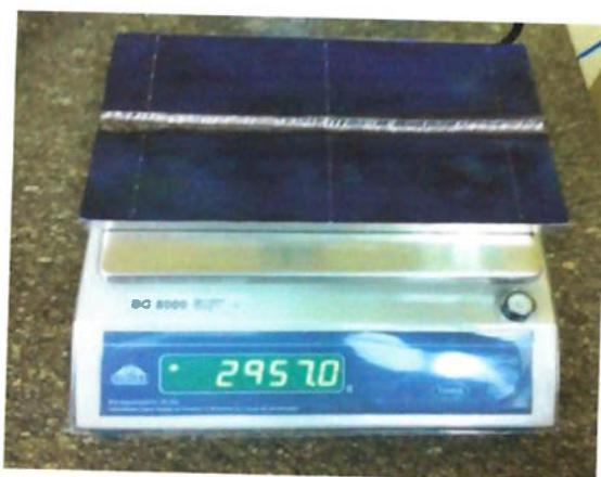
**Figura 4.14** - Foto da pesagem do corpo de prova após a goivagem.
