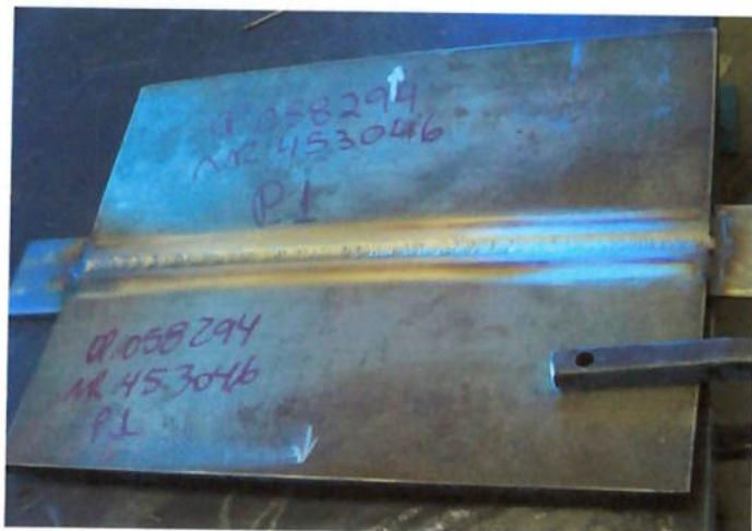
**Figura 4.4** - Foto do corpo de prova (TIG) soldado.
