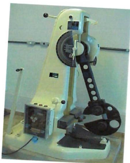
**Figura 4.20** - Máquina utilizada para realizar o ensaio de Charpy.
