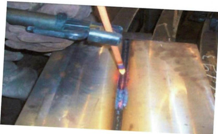
**Figura 2.26** - Goivagem a arco elétrico .
