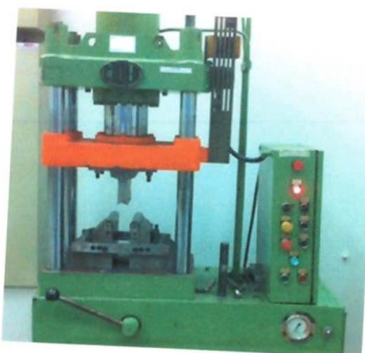
**Figura 4.18** - Máquina utilizada para realizar o ensaio de Dobramento.
